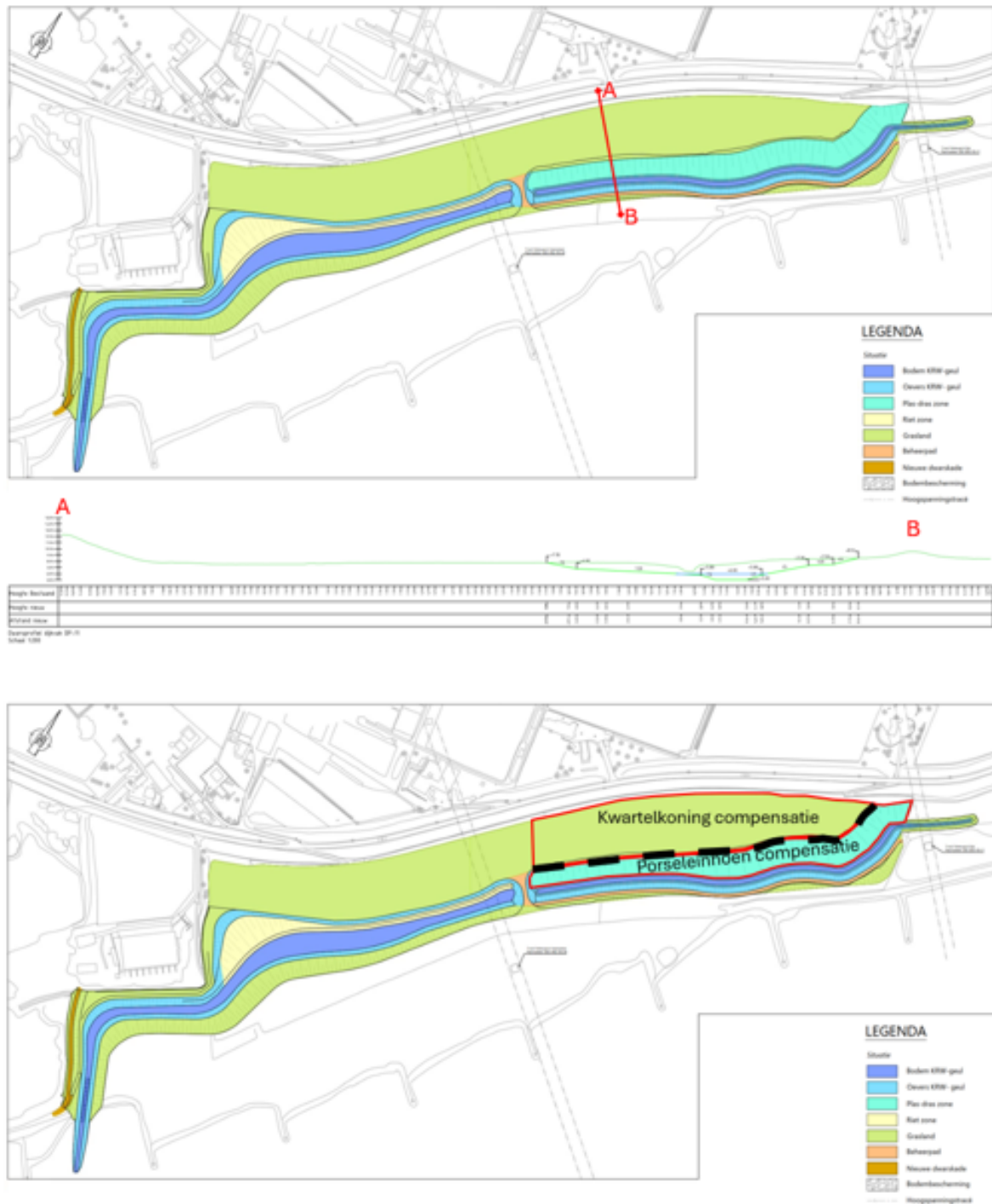
Afbeelding 5.6 Ontwerp van de geul met dwarsprofiel langs de lijn A - B (boven), ligging compensatiegebied kwartelkoning en porseleinhoen en zachte scheiding (stippellijn) tussen de habitats van beide soorten (onder). Bron Ontwerpdata gebiedsambitie KRW-geul en NURG in de oostelijke Plasserwaard, referentienummer 124281-2.1/25-001.281
