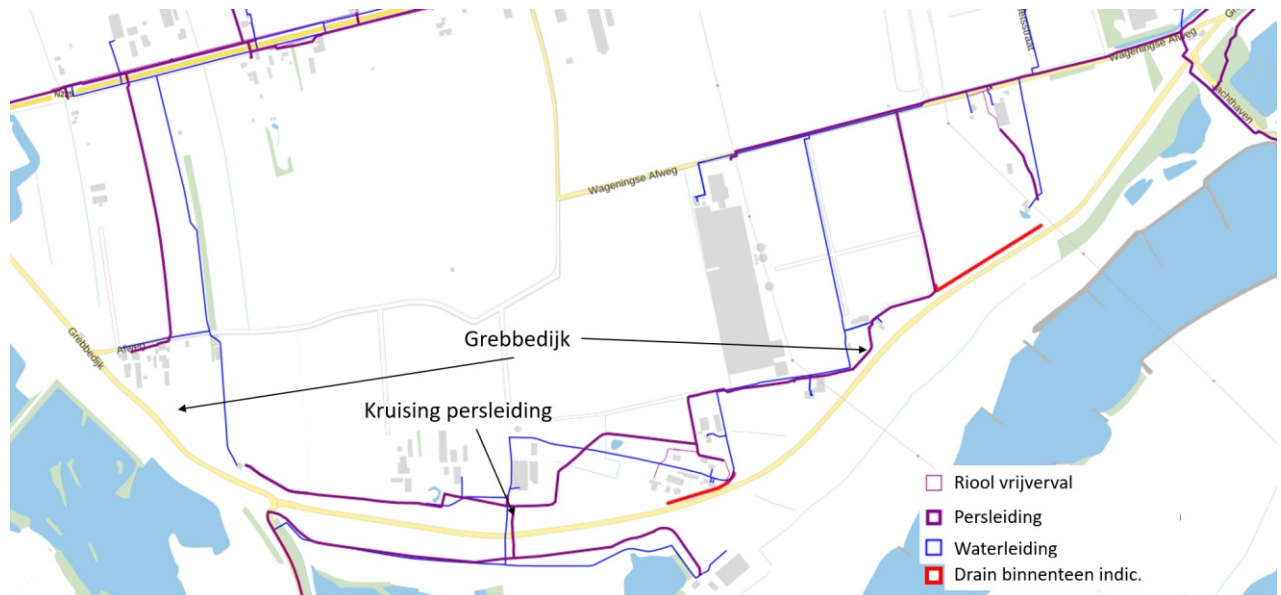
Afbeelding 3.28 Detail van de riolering, persleiding en waterleiding in deelgebied 3
