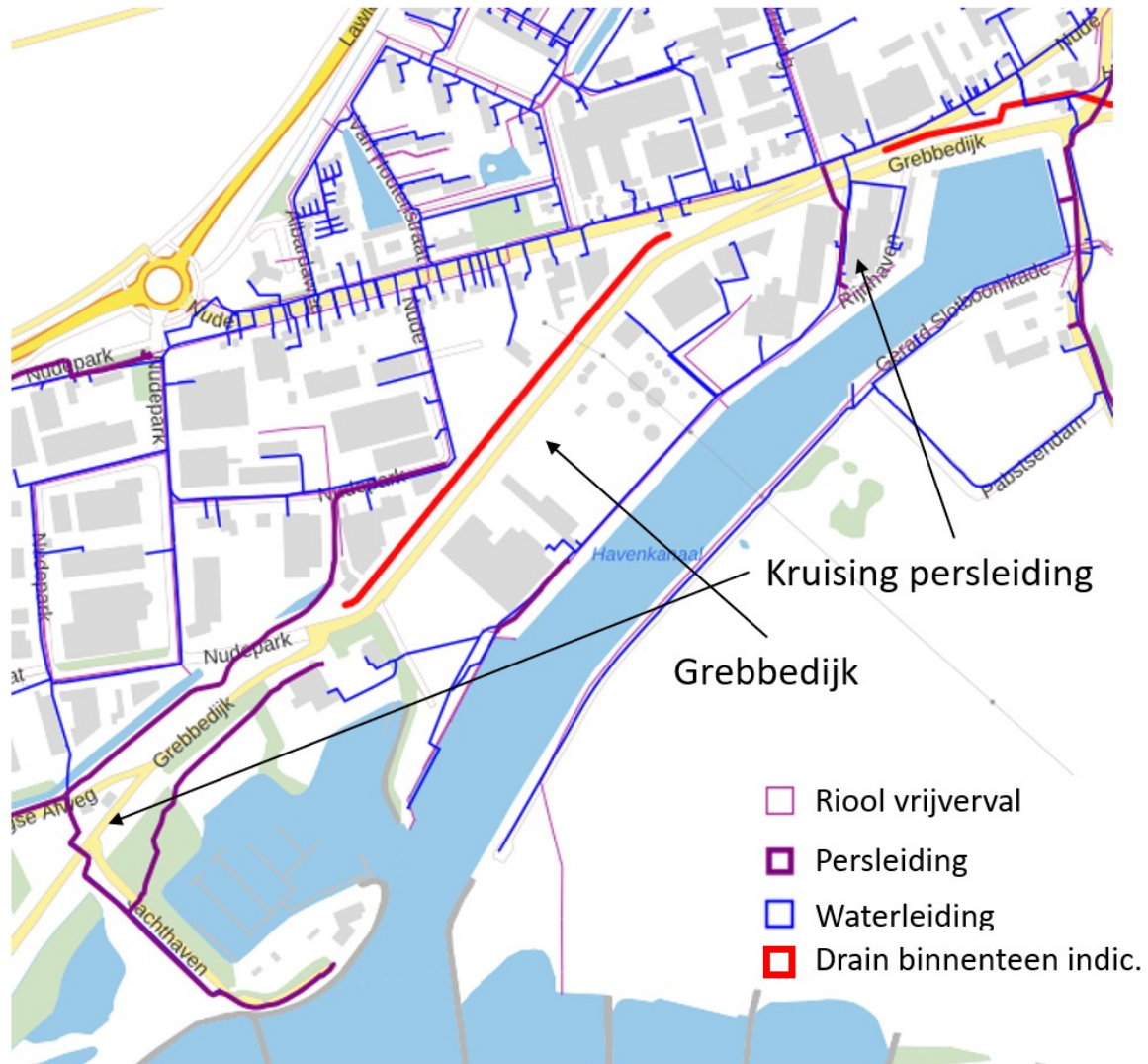
Afbeelding 3.27 Detail van de riolering, persleiding en waterleiding in deelgebied 2
