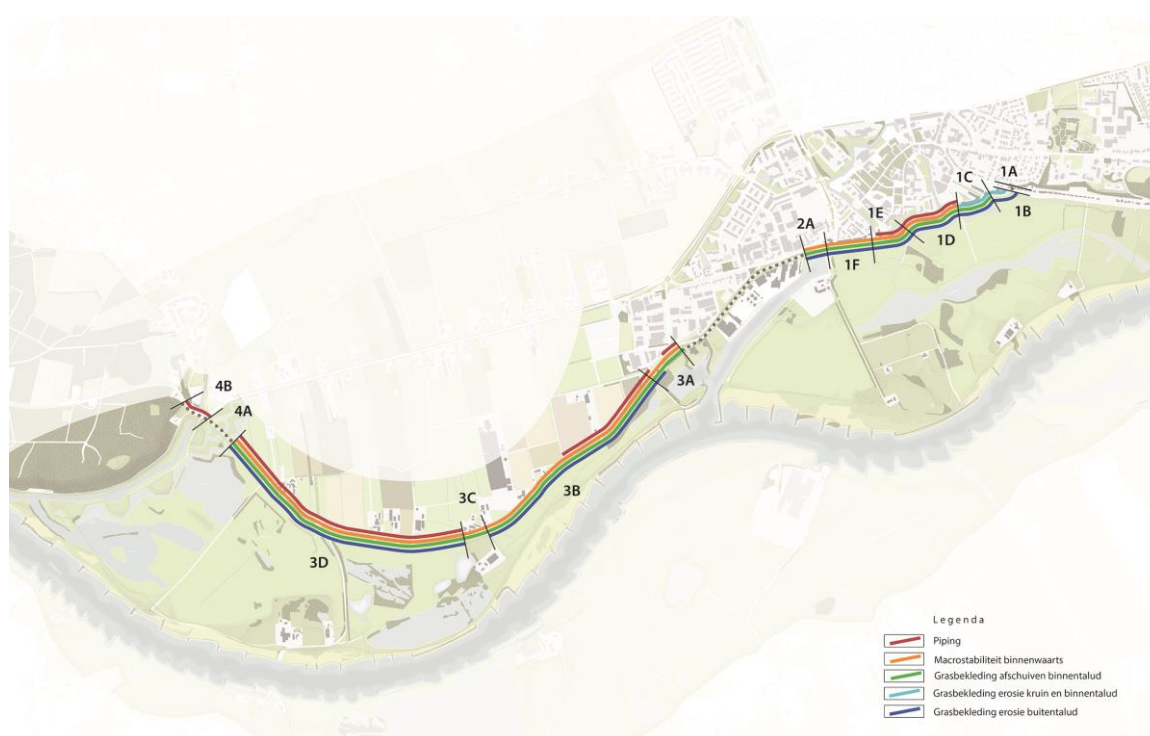
Afbeelding 1.6 Belangrijkste faalmechanismen Grebbedijk per dijkvak
