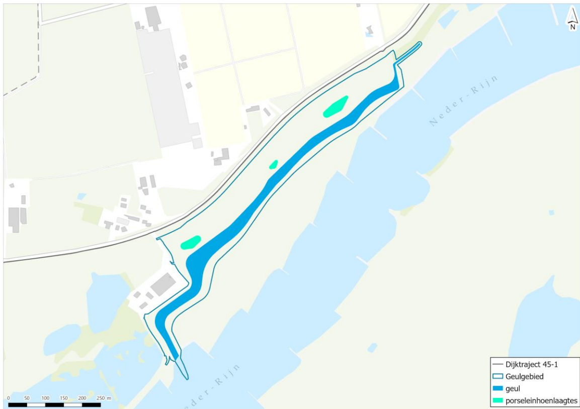
Afbeelding 2.2 Oud ontwerp geulgebied met ligging geul en de aanvullende porseleinhoenlaagtes (de plasdraszone langs de geul telde hier ook voor mee, deze was niet weergegeven in MER deel 2)
