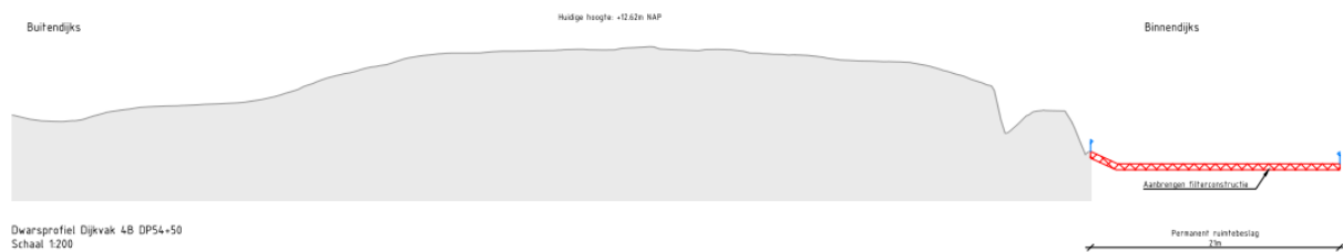
Afbeelding 3: Dwarsprofiel filterconstructie (Bron: Bijlage 9.18 Projectbesluit)
